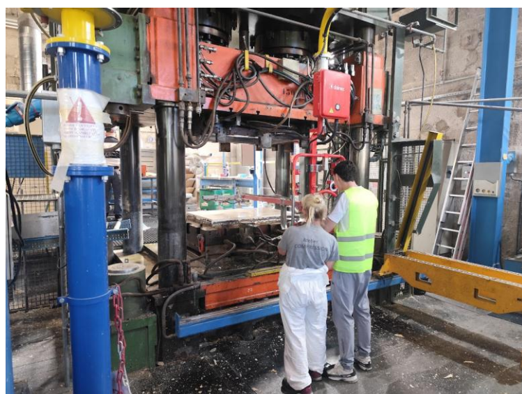
Pressage d'une porte de coffret grâce à une presse de 1500 tonnes
