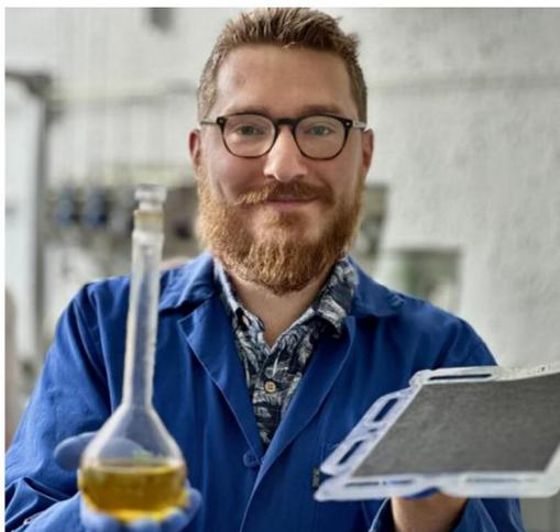
François Guillet, sur l'amélioration d'un procédé de récupération du platine par électrochimie dans le recyclage des piles à combustible (PAC) et des électrolyseurs. Dans ses mains, une fiole contenant les sels de platine récupéré du cœur de la PAC (ici à droite de l'image).
