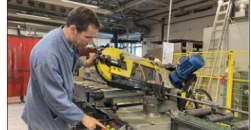
La scie à ruban utilisée pour découper les tubes en métal.
